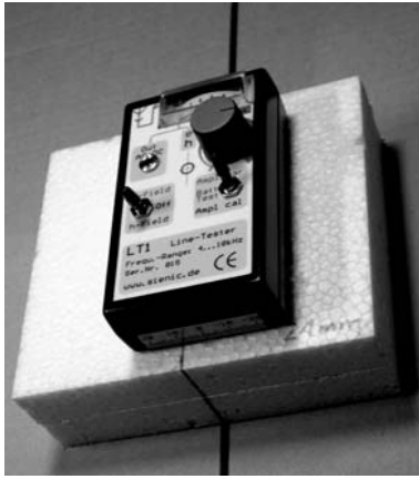
Fig. 6 LT1-Position bei Messung der seitlichen Deformation und Messmethode 1. Seitenabweichung +10 mm. Bei Messmethode 2 ist LT1 mittig über Leitdraht. Siehe 3.4.1-3
