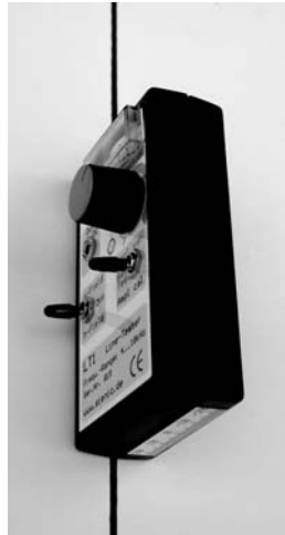
Fig. 7 LT1-Position bei Messung des Leitdrahtstromes und Leitdrahttiefe LT1 längsseitig, vertikal und mittig über dem Leitdraht. Siehe 3.1-3
